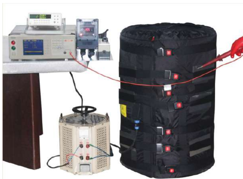
Messgeräte für den Gesamtableitstrom im heißen Zustand
